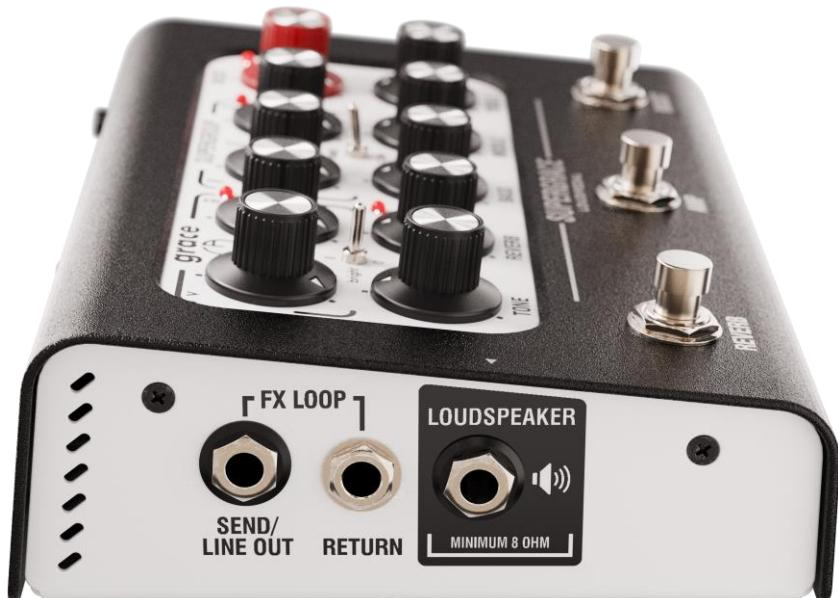
**ENVÍO DE EFECTOS / SALIDA DE LÍNEA (TRANSFORMADOR AISLADO)**
