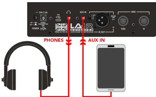
SUPERGRACE 配备高品质耳机输出接口，方便静音练习。它针对高阻抗耳机（例如常见的  $33\Omega$  耳机）进行了优化，但也支持其他阻抗的耳机。
