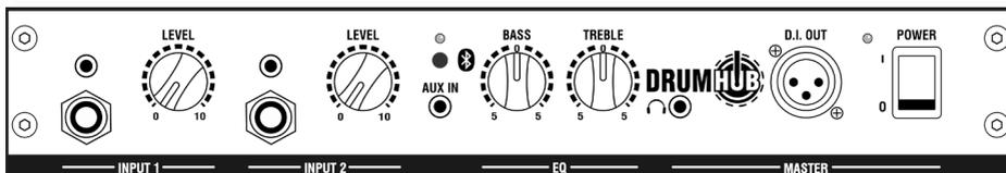
通道1: 包含有两个输入端口, 3.5mm插座和6.35mm插座。两个都是立体声输入,可以同时使用,连接你的鼓系统或者其他线路输入,同样支持单声道插头。
