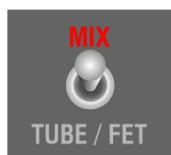
**MIX** - O pedal alternará entre a mixagem do canal FET e a mixagem de um canal FET+Válvula.
