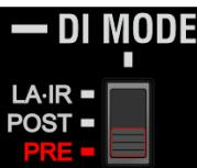
**— DI MODE —** **PRE** - Sinal proveniente do estágio frontal do pedal, logo após a seleção de entrada, antes dos canais FET/Tube, EQ e loop de efeitos.
