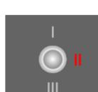
**II** - Característica semelhante à posição superior, mas ainda mais acentuada para produzir um som valvulado mais distorcido. Clipping ainda mais assimétrico. Pode ser usado para ajustar uma distorção de graves de "leve" a "total", mantendo a definição e a clareza. Experimente com o controle RANGE para encontrar o seu som perfeito.
