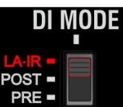
**DI MODE** **LA-IR** - Semelhante à versão anterior, mas com as respostas ao impulso (IRs) de entrada correspondentes ativadas, bem como qualquer equalização (EQ) ajustada pelo usuário no aplicativo LA-IR. Cada entrada possui sua própria IR pré-carregada, porém estas podem ser substituídas pelas suas próprias através do aplicativo LA-IR.
