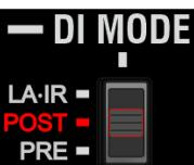
**— DI MODE —** **POST** - O sinal padrão, incluindo os canais FET/Válvula, equalizador e o loop de efeitos. Não é afetado pelo volume master.
