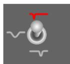
**スイッチアップ** - 低中域を狭くカットしたこのサウンドは、ドラマーと共に演する際にベースの明瞭度を高めるのに最適です。スイッチを引けばキックとスネアに余裕が生まれ、スイッチを引けばベースがドラムの前に出るようになります。
