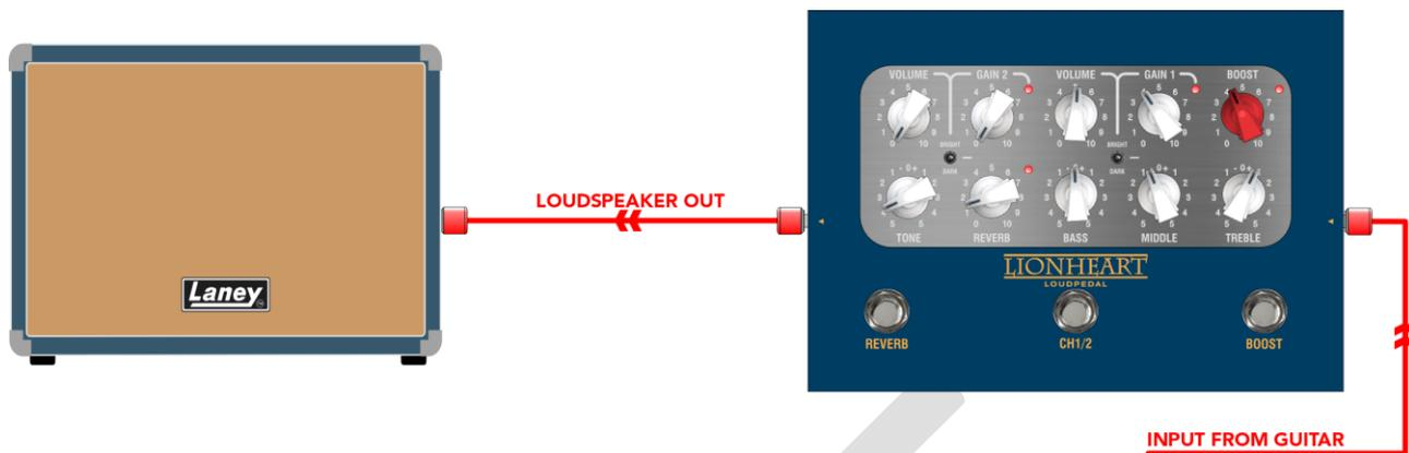
Il BCC-LOUDPEDAL-LTQ può funzionare proprio come una normale testata, collegato direttamente a un cabinet per altoparlanti passivi. È rumoroso.
