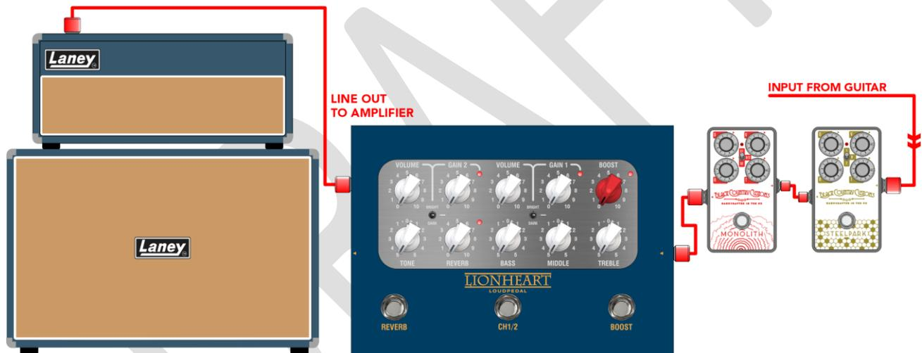
Il BCC-LOUDPEDAL-LTQ può essere collegato in serie con la normale configurazione del pedale per fungere da pedale di guadagno a doppio canale con boost aggiuntivo. Collega la presa di mandata FX alla testata dell'amplificatore.
