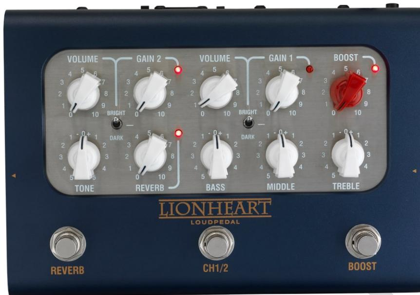
Grazie alla sua configurazione a doppio canale, BCC-LOUDPEDAL-LTQ consente di passare facilmente tra due set di toni, tramite interruttore a pedale o MIDI. Ogni canale ha le proprie impostazioni di guadagno, volume e tono con BOOST E REVERB commutabili, sempre tramite interruttore a pedale o MIDI.
