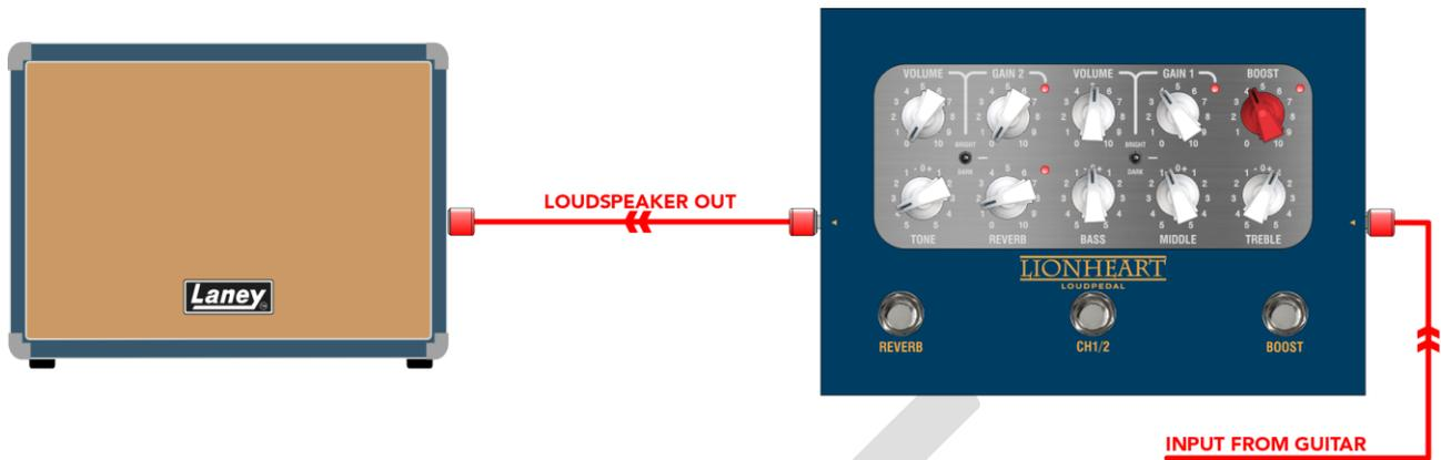
El BCC-LOUDPEDAL-LTQ puede funcionar como un cabezal normal, conectado directamente a un gabinete de altavoz pasivo. Es ruidoso.
