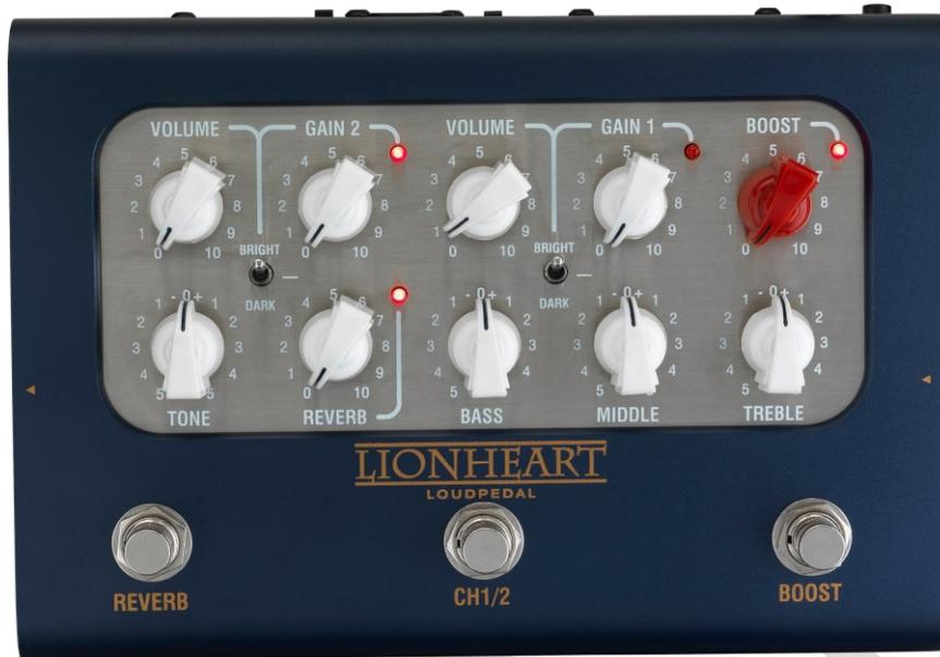
Gracias a su configuración de doble canal, el BCC-LOUDPEDAL-LTQ le permite cambiar fácilmente entre dos tonos configurados, mediante un interruptor de pedal o MIDI. Cada canal tiene sus propios ajustes de ganancia, volumen y tono con BOOST Y REVERB conmutables, nuevamente mediante pedal o MIDI.
