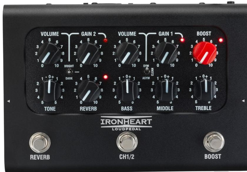
Grâce à sa configuration double canal, le BCC-LOUDPEDAL-IMM vous permet de basculer facilement entre deux jeux de tonalités, via un footswitch ou MIDI. Chaque canal possède son propre contrôle de gain, de volume et de tonalité avec BOOST et REVERB commutables, toujours via un footswitch ou MIDI.
